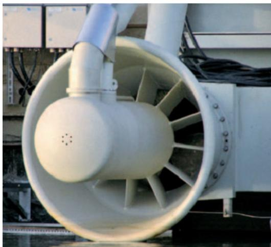
Рис. 1 – Генератор с турбиной HYDROMATRIX
