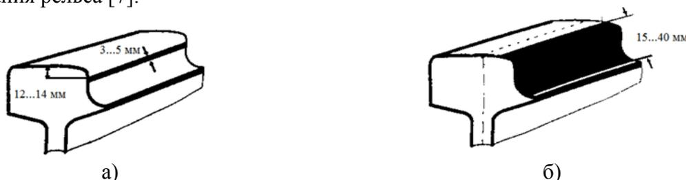
Рис. 3 – Норматив качества нанесения рельсовой смазки:
