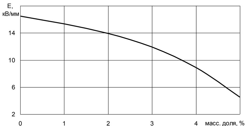
Рис. 3. Зависимость электрической прочности композитов от содержания массовой доли сажи.
