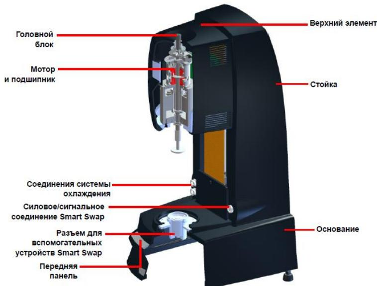
Рис.1– Реометр серии DHR
