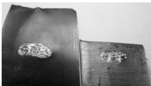
Рис. 3. Образец тонколистовой меди со сварным швом после проведения исследований прочности соединения
