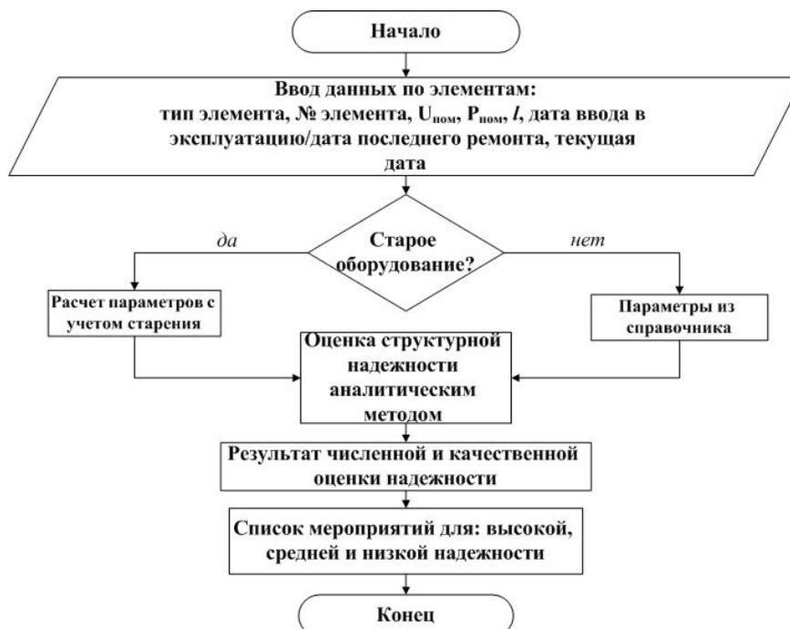
Рис. 2 – Алгоритм реализации методики оценки надежности СЭС нефтяного месторождения
