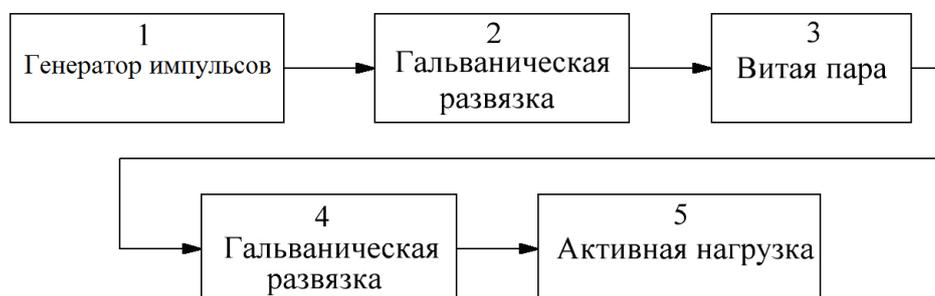
Рисунок 1. Структурная схема системы передачи управляющего сигнала
