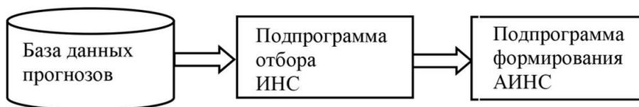
Рис.1 – Блок-схема системы процесса формирования ансамблей искусственных нейронных сетей (АИНС)
