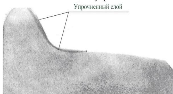
Рис. Поперечный шлиф обода термоупрочненного колеса
