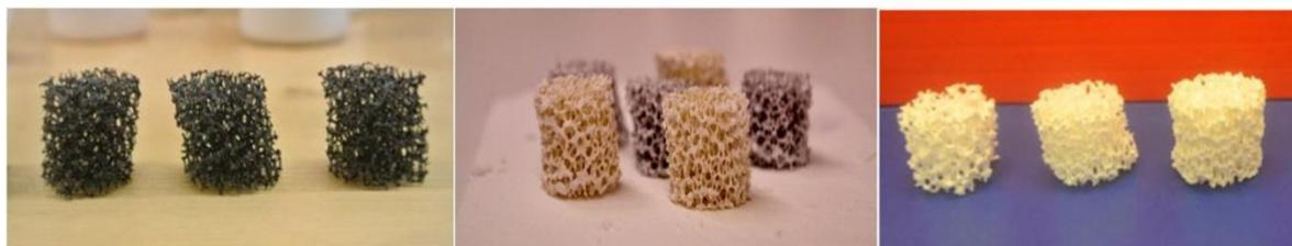
Рис. 1 – подготовленная ПУ матрица; ПУ матрица, с керамической суспензией на поверхности; пористый керамический носитель
