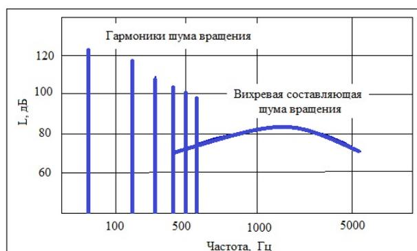
Рис. 1 - Типичный спектр шума воздушного винта
