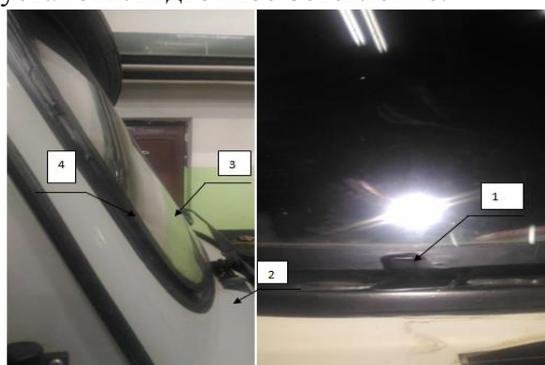
Рис. 2- Общий вид двойного остекления: 1-поддерживающая деталь; 2-кузов транспортного средства; 3-двойное стекло; 4-клеевое соединение
