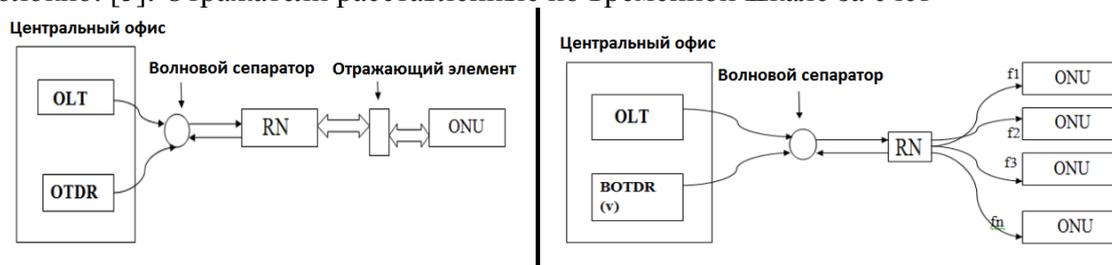
Рис. 4 - Системы мониторинга ПОС а) с использованием светоотражающих элементов; б) с использованием сдвига частоты Бриллюэна
