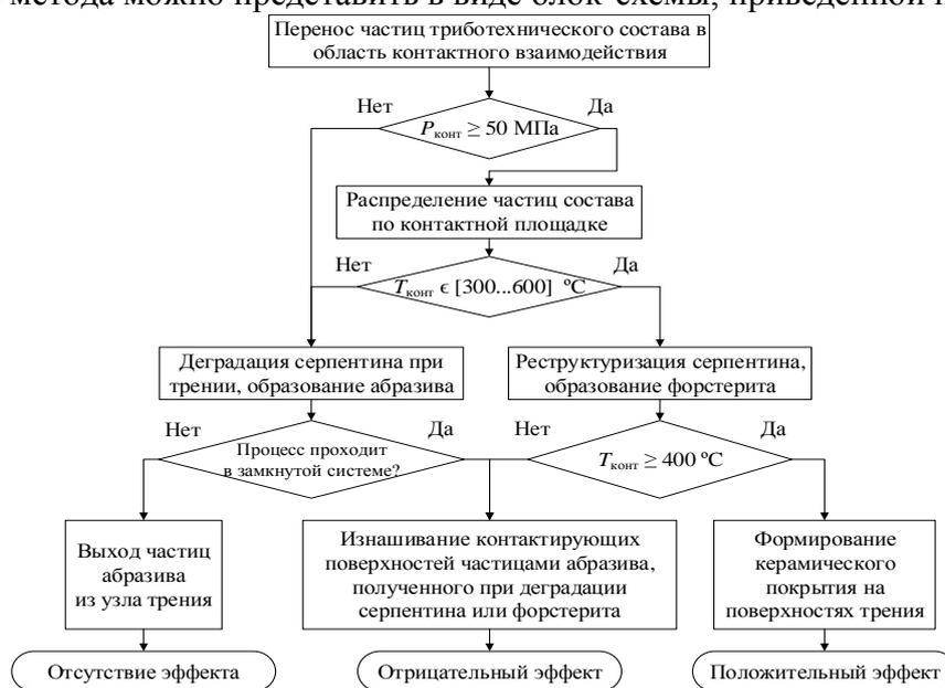
Рис. Блок-схема процесса формирования покрытия
