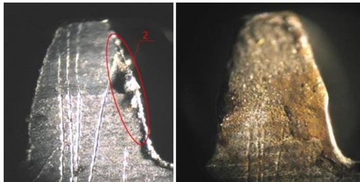
Рис. 5- Фотографии кромок детали до (слева) и после (справа) 2 часов кавитационной обработки в абразивной суспензии
