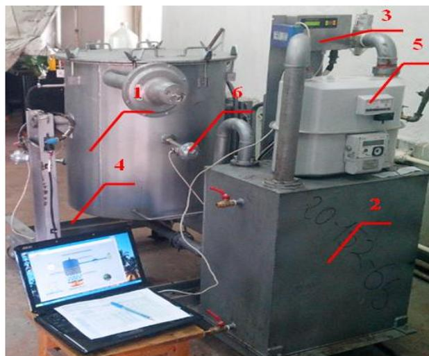
Рис. 1- ГВА-1: 1 – терморреактор, 2 – гидрозатвор, 3 - электронный блок контроля и управления, 4 – рама, 5 - газовое оборудование, 6 - датчики температуры.
