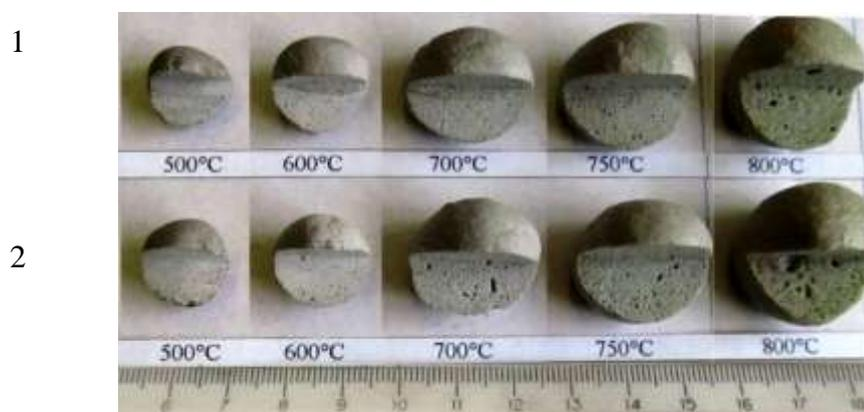
**Рис. 2 – Изменение объема и пористости гранул из композиций стеклобоя с добавкой 40% (1) и 30% (2) высококальциевого шлака в зависимости от температуры обжига.**
