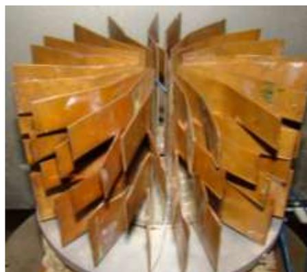
**Рис.4. Внешний вид рабочего участка с разрезными ребрами.**
