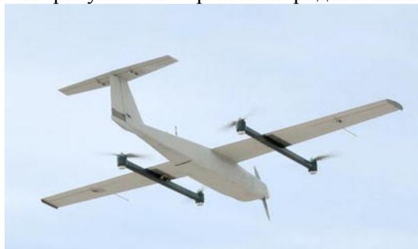
Рис. 4 – Гибридный беспилотный летательный аппарат с неподвижным крылом и несколькими роторами
