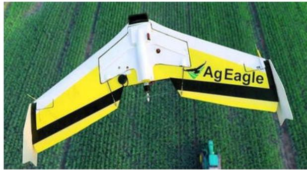
Рис. 2 – Беспилотный летательный аппарат с неподвижным крылом
