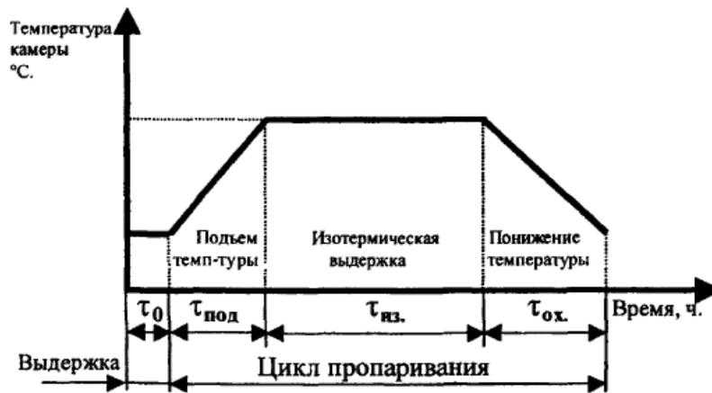
Рис. 1 - График трапецеидального режима тепловлажностной обработки
