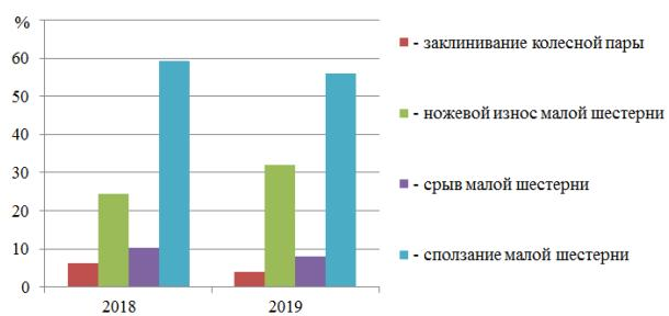
Рис. 9. Причины выкатки колесно-моторных блоков, связанные с неисправностью тягового привода
