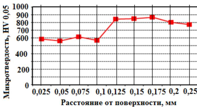
Рис. 2. График изменения микротвёрдости в единицах HV<sub>0,05</sub> по глубине после наплавки
