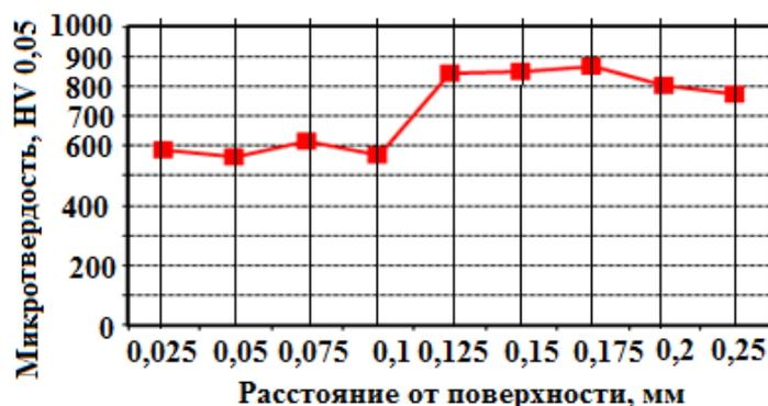
Рис. 2. График изменения микротвёрдости в единицах  $HV_{0,05}$  по глубине после наплавки
