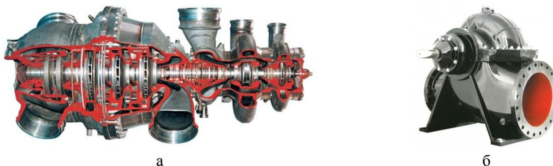
Рис. 1 – Центробежные насосы: а – центробежный насос в составе ТНА РД-120, б – нефтяной центробежный насос
