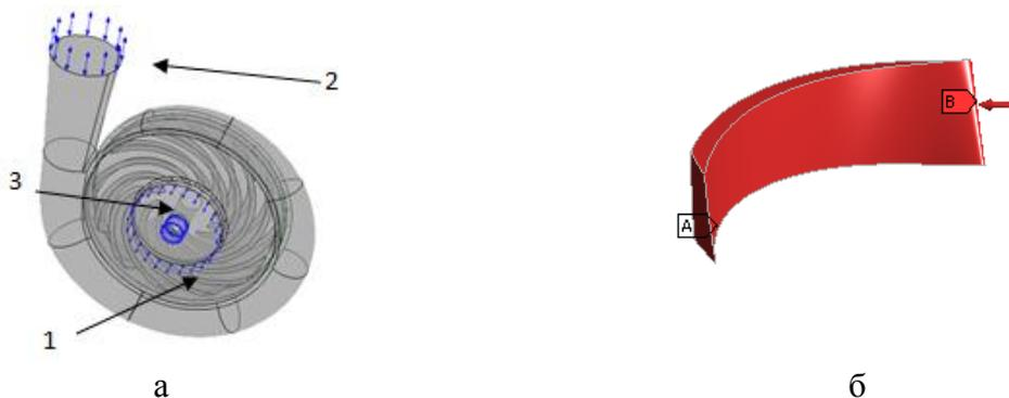
Рис. 2 – Граничные условия: а – жидкостной регион: 1 – свободный вход-выход давление на входе 3 атм., 2 – выход, 3 – скорость вращения рабочих колес 4500 об/мин., б – передаваемая нагрузка на лопатку: А – консольное закрепление по нижней кромке, В – передаваемая через *FSI* интерфейс нагрузка из гидродинамического расчета.
