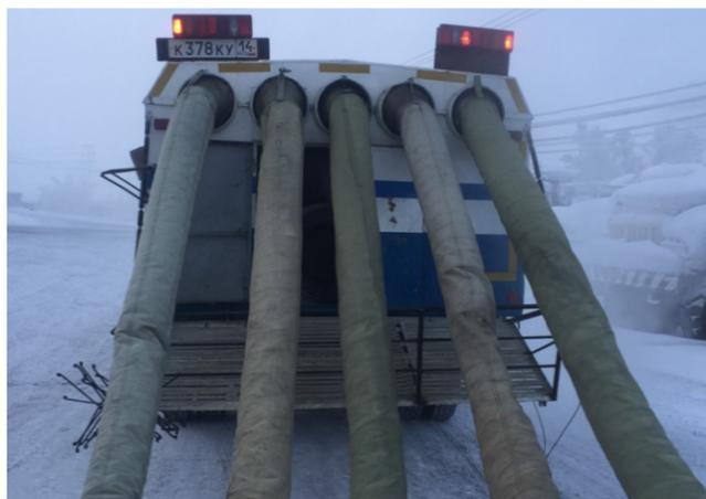
Рис. 3 – Установленные раструбы в УМП-350
