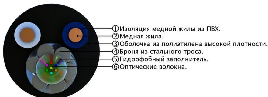
Рис. 3 – Комбинированный кабель (разрез)
