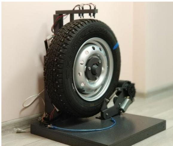
Рис. 2 – Макет станда для автоматизированного подсчёта шипов
