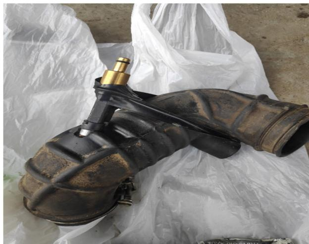
Рис. 2 – Установка водотопливной форсунки
