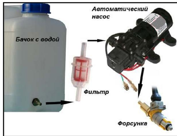
Рис. 1 – Схема подключения шлангов в системе с автоматическим насосом
