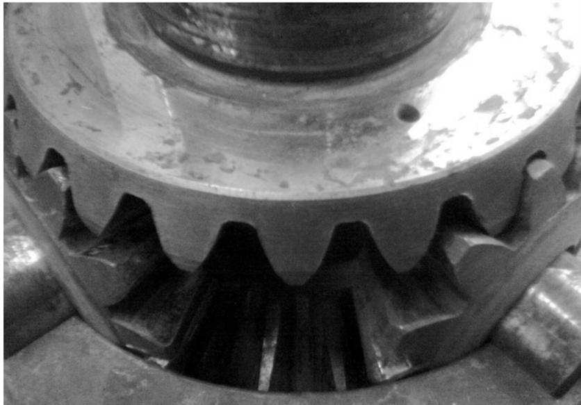
Рис. 1 – Полуосевая шестерня межколёсного дифференциала в контакте с сателлитами
