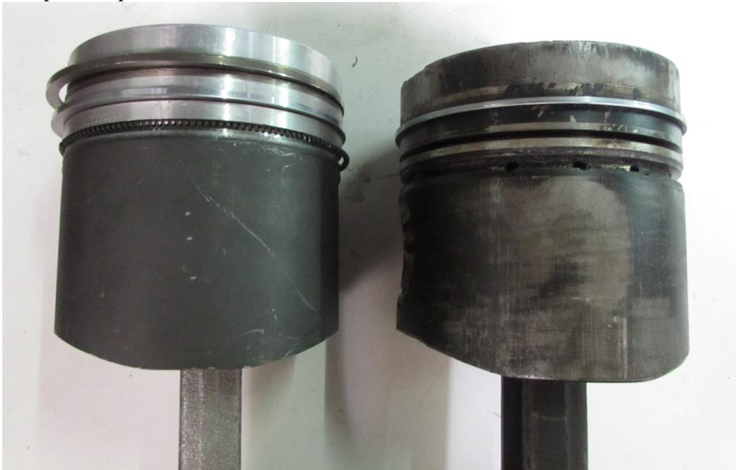
Рис. 1 – Новый и изношенный поршни двигателя КАМАЗ
