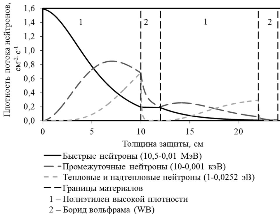
Рис. 3 – Ослабление плотности потока нейтронов спектра источника с расстоянием в композитном материале
