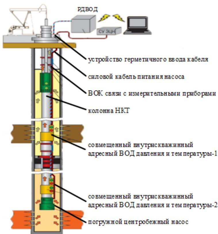
Рис. 1 – Скважина одновременно-раздельной добычи с набором сдвоенных ДВБС
