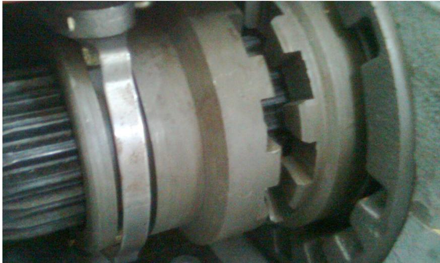
Рис. 1 – Муфта блокировки межколёсного дифференциала грузового автомобиля КАМАЗ
