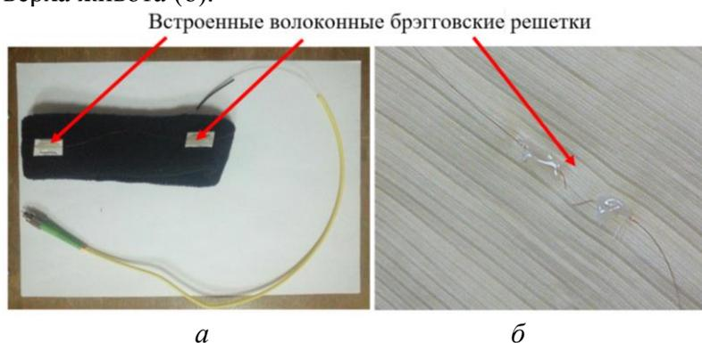
Рис. 2–Датчик для мониторинга сигналов сердцебиения (а) и дыхания (б)
