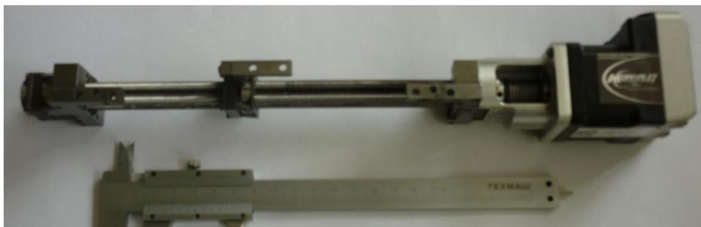
Рис.1. Мехатронный привод поступательного перемещения для оптического столика ВЛГУ на базе ИМ РВП 3К
