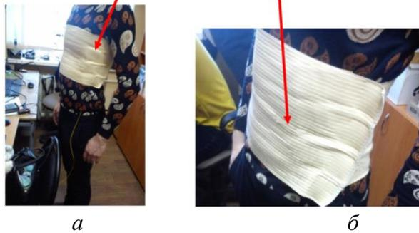
Рис. 3 – Измерение сигналов сердцебиения в области грудной клетки (а) и измерение характеристик дыхания в области верха живота (б)
