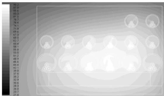
Рисунок 2. Тепловое поле при работе всей кабельной линии, рабочий ток 110 А. (6x35кВ+8x6кВ)
