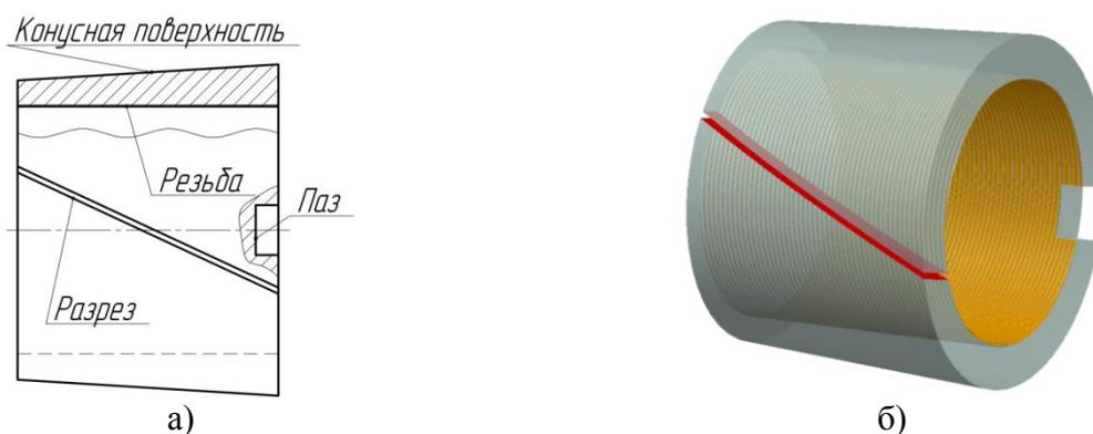
Рис. 1. Разрезная гайка РВМ
