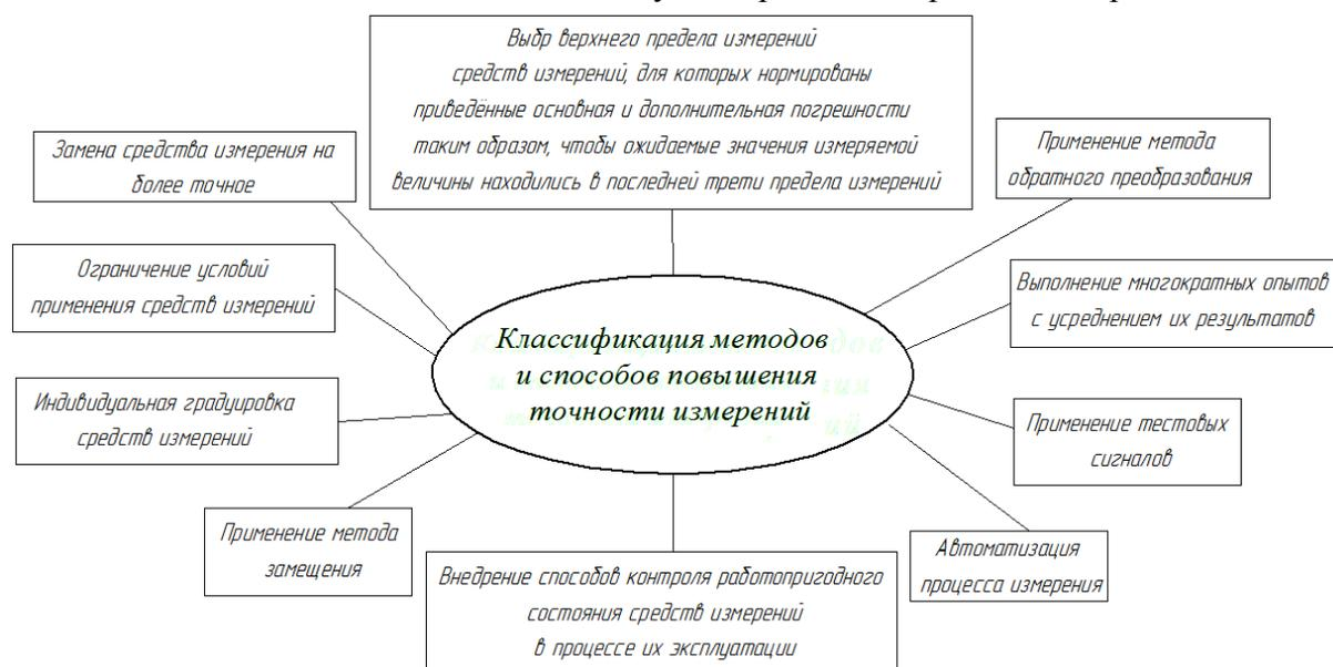
Рис. 1. – Классификация методов и способов повышения точности измерений
