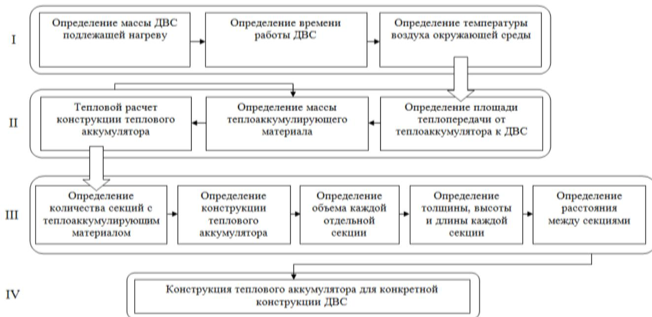
**Рис.3 - Методика проектирования теплового аккумулятора ДВС.**
