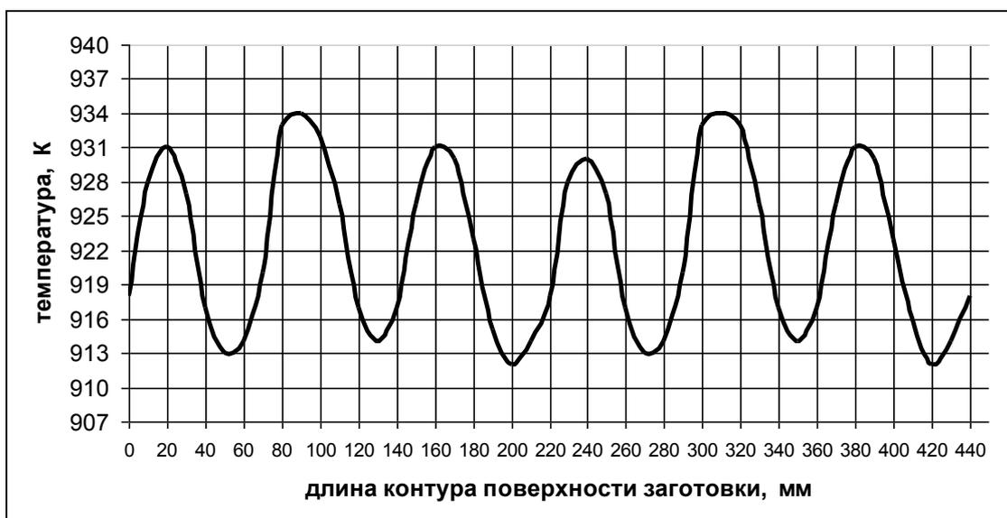
**Рис. 4 - Распределение температуры по контуру поверхности заготовки.**
