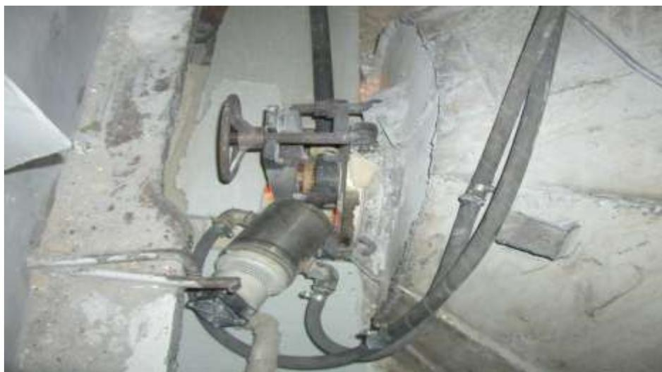
**Рис. 2 – Печь pulverизации с установленной ультразвуковой колебательной системой.**
