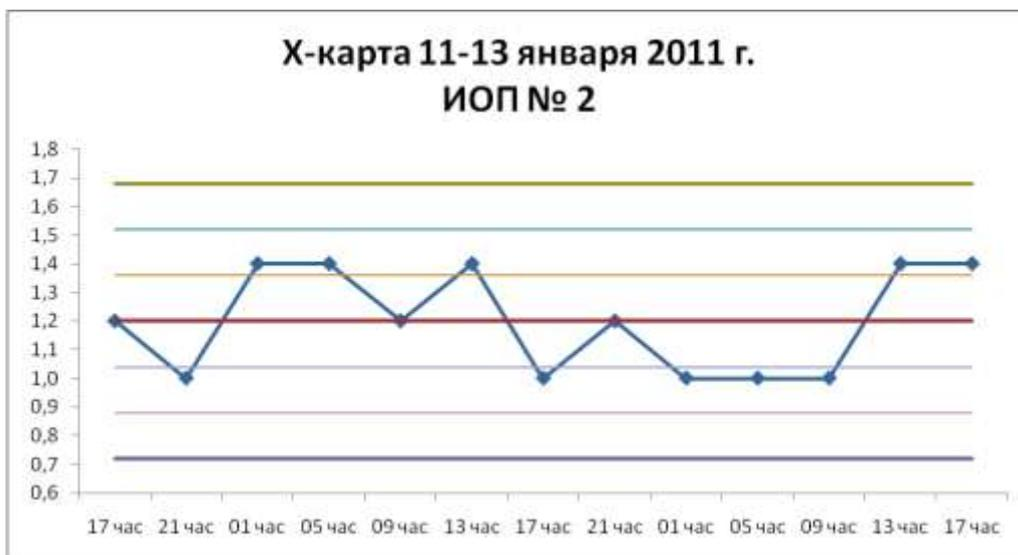
**Рис. 3 – X-карта содержания кислорода в газе известково-обжигательной печи №2 при ВКГ=1,68.**
