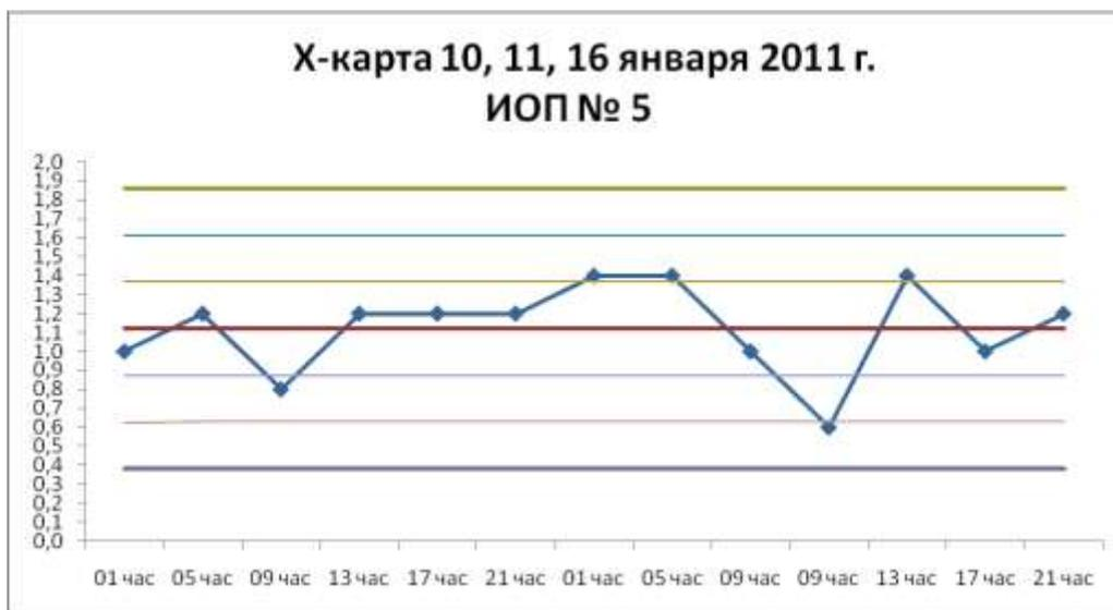
**Рис. 5 – X-карта содержания кислорода в газе известково-обжигательной печи №5 при ВКГ=1,86.**
