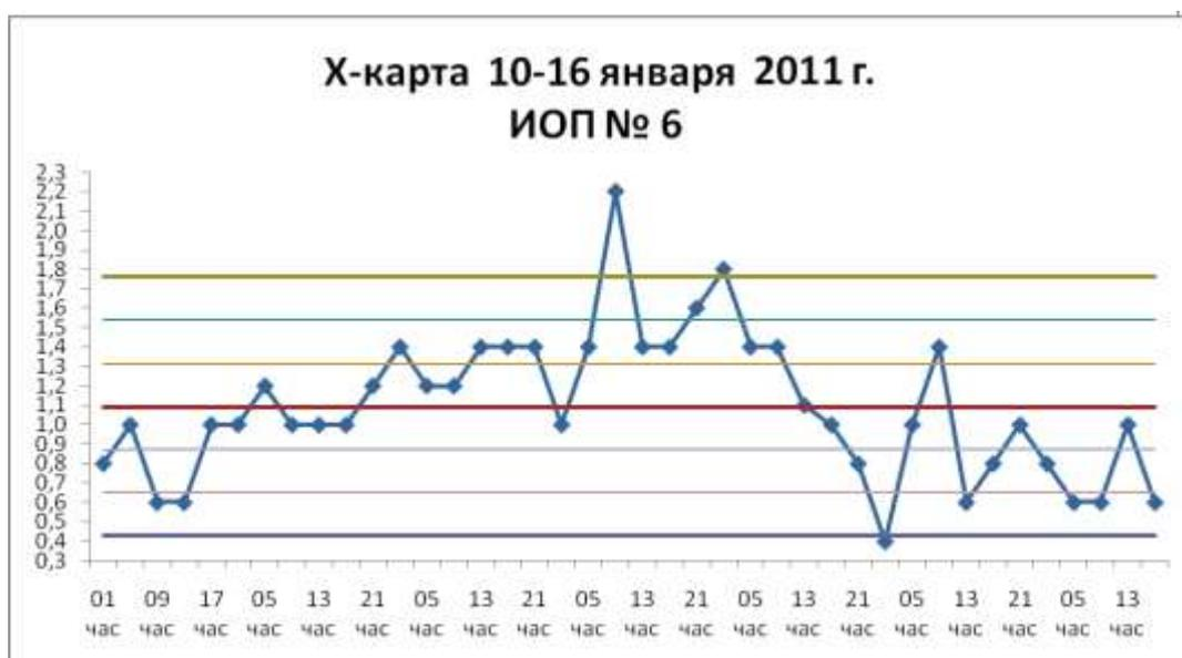
**Рис. 6 – X-карта содержания кислорода в газе известково-обжигательной печи №6 при ВКГ=1,78.**
