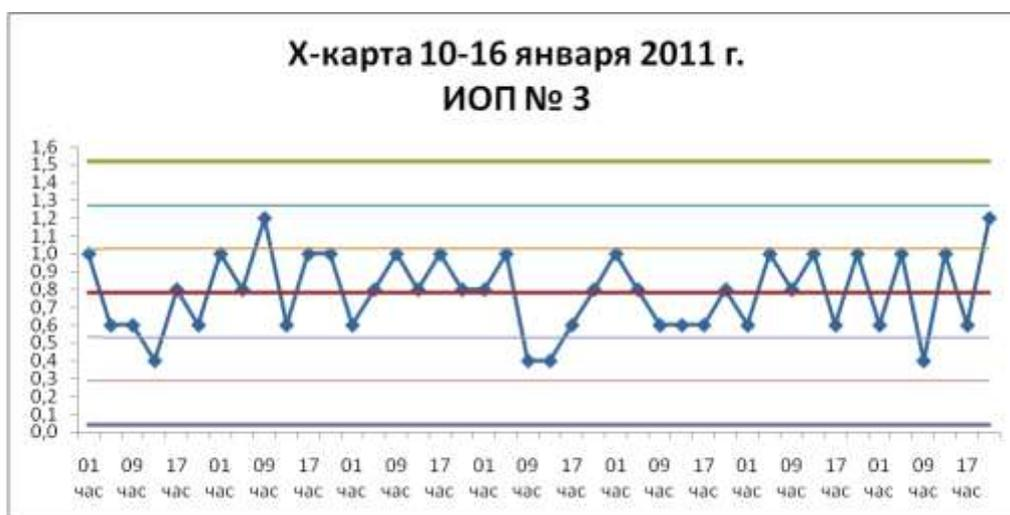
**Рис. 4 – X-карта содержания кислорода в газе известково-обжигательной печи №3 при ВКГ=1,52.**
