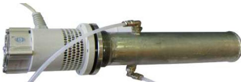
**Рис. 2 – Модернизированный излучатель ультразвукового аппарата «Волна-М».**
