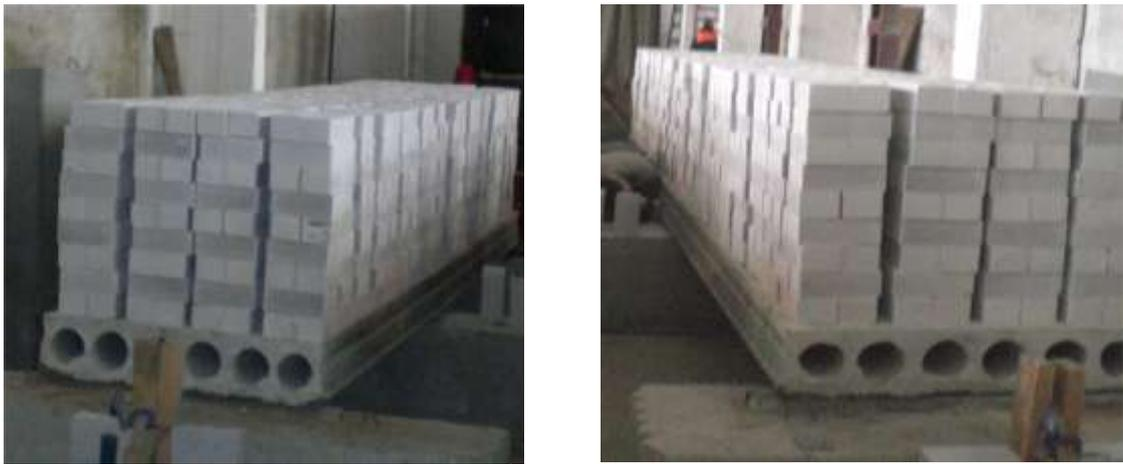
**Рис.1. Фрагмент загрузки плит.**
