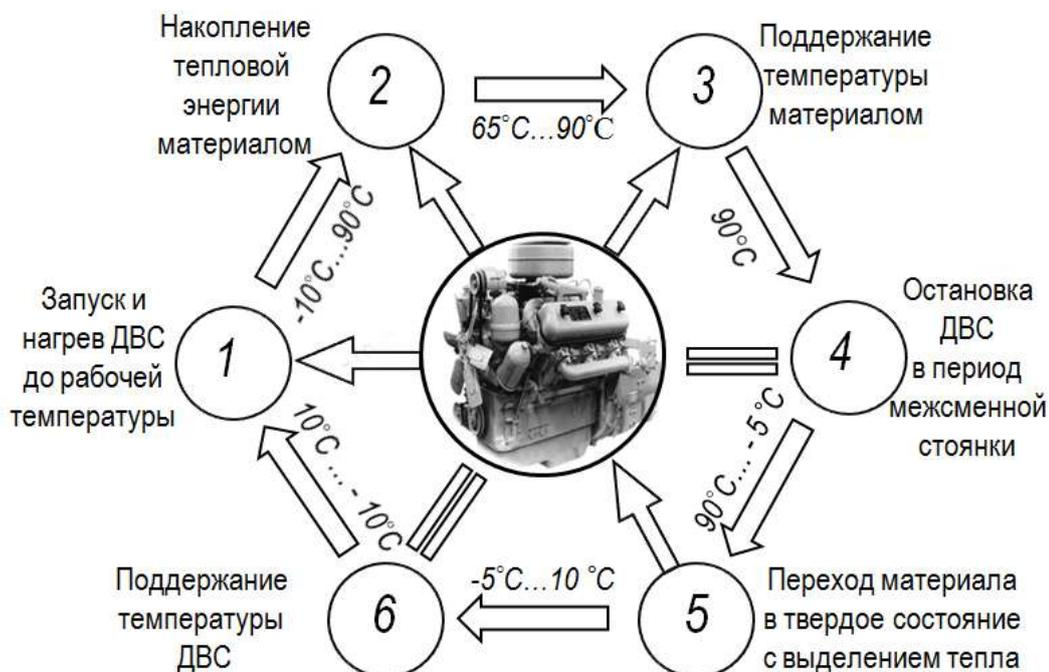
**Рис.2 - Рабочий процесс теплового аккумулятора ДВС машины.**
