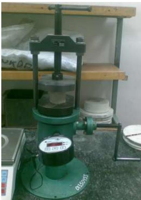
**Рис. 2 - Испытание образцов на прессе ПРГ-1-50.**
