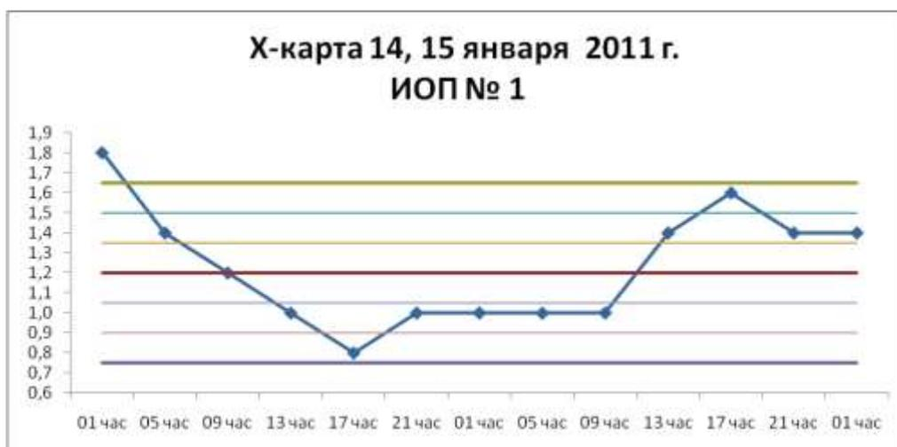
**Рис. 2 – X-карта содержания кислорода в газе известково-обжигательной печи №1 при ВКГ=1,65.**
