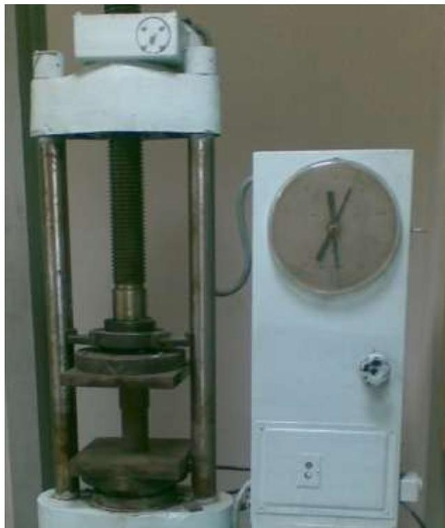
**Рис. 1 - Изготовление образцов на прессе КП-902.**
