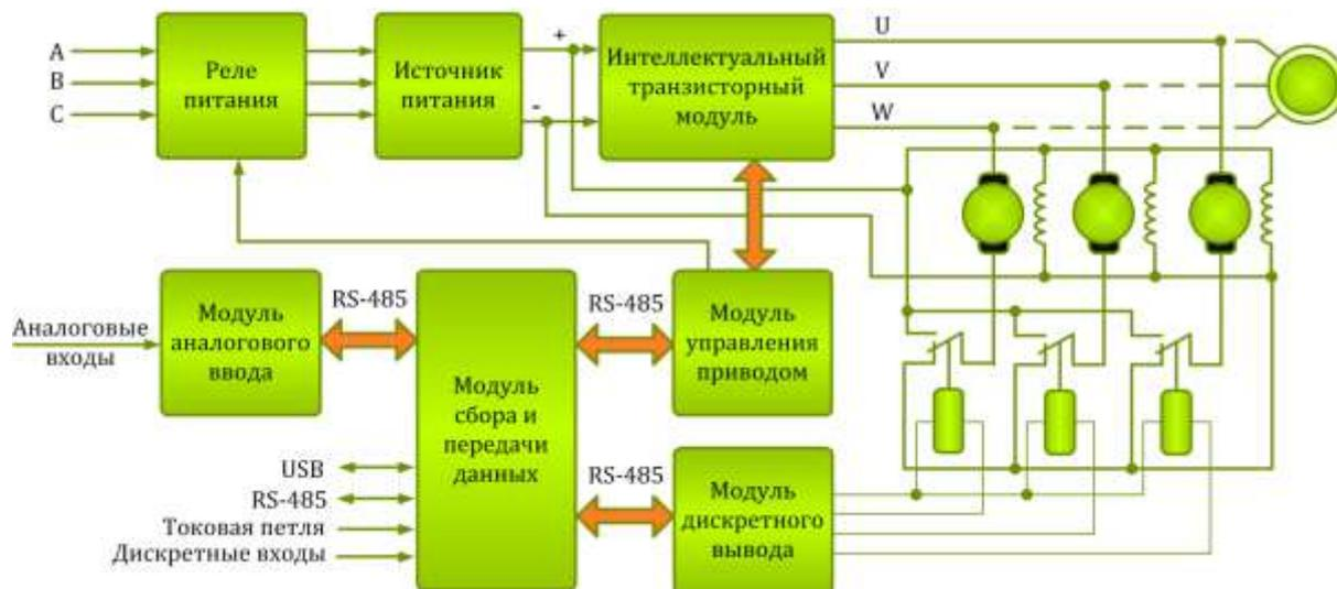
**Рис. 1. Структурная схема устройства управления электроприводом.**
