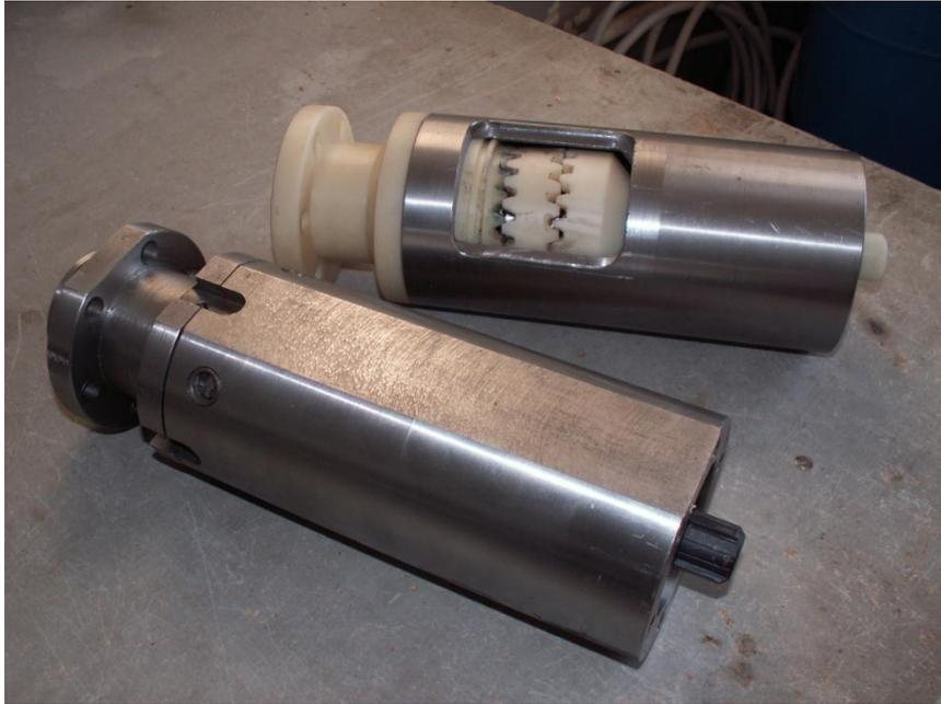
Рис.4 - Изготовленные модель и опытный образец редуктора
