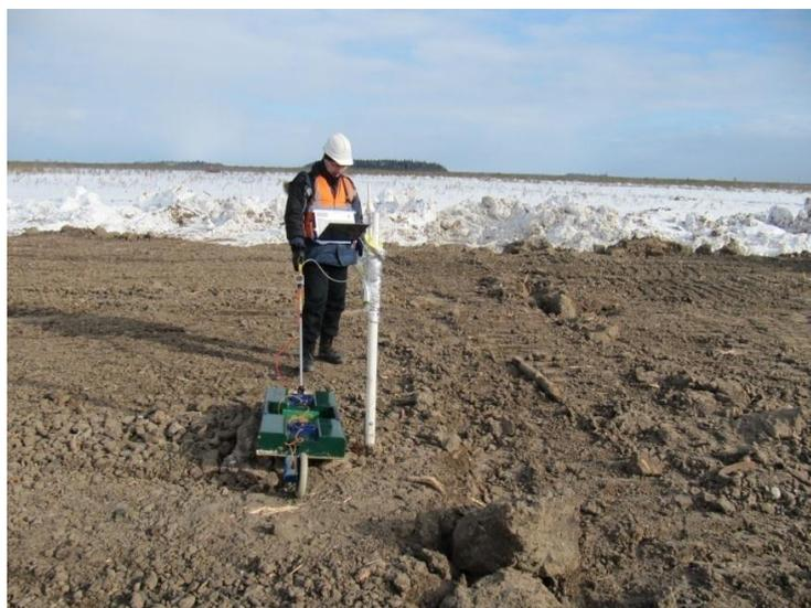
Рис. 1- Определение физических характеристик грунтов георадарным зондированием
