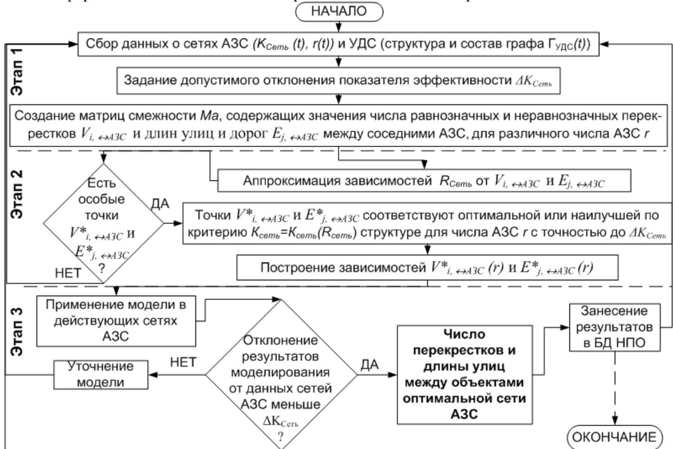
Рис. 3. Информационно-логическая схема размещения АЗС с учетом характеристик УДС
