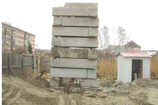
Рис. 1 - Испытание основания усиленного песчаной армированной сваей под статической нагрузкой.
